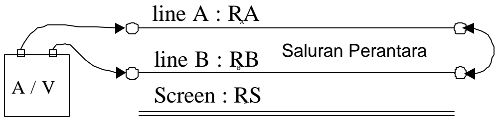
Gambar : Pengukuran R_1 tahanan konduktor A dan konduktor B
